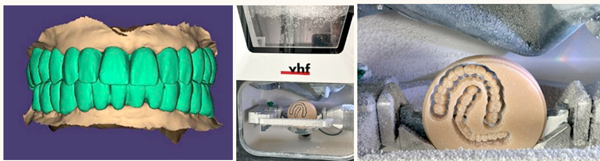
Figs. 7. Diseño digital y elaboración fresada de prótesis de PMMA.
