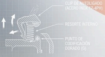
DETALLE DE MECANISMO DE AUTOLIGADO
