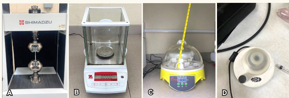
Fig. 3 A-D). Equipo. A) Máquina de ensayos universales (Shimadzu AG-IC-100 KN); B) Balanza (OHAUS Adventurer); C) Incubadora (Azewe HDD); D) Agitador (Vortex Roca).
